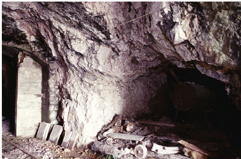
Detall dels estrats pocs inclinats de l'interior de la mina de Vallcebre.
